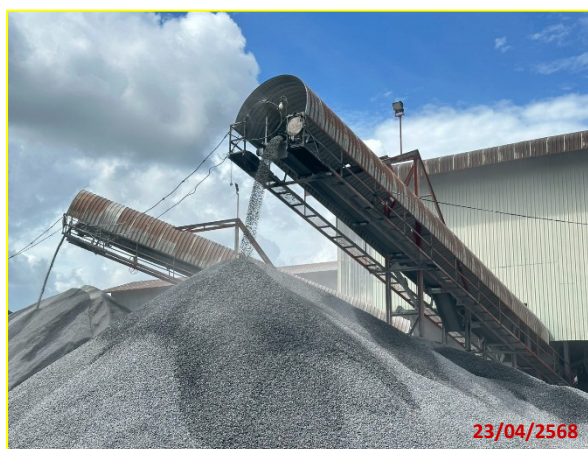
ภาพที่ 2-9 โรงโม่หินของโครงการปิดคลุม 3 ด้าน และระบบสเปรย์น้ำบริเวณปลายสายพานลำเลียง
